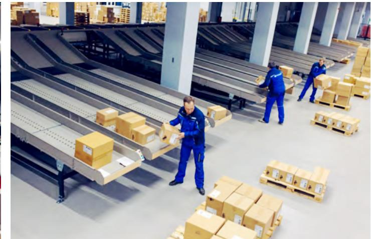
Автоматизированная сортировка товара используется для формирования заказов посредством станций депалетирования и ленточного конвейера. Производительность системы сортировки — 4 000 коробок\час с одновременной обработкой 30 заказов.
